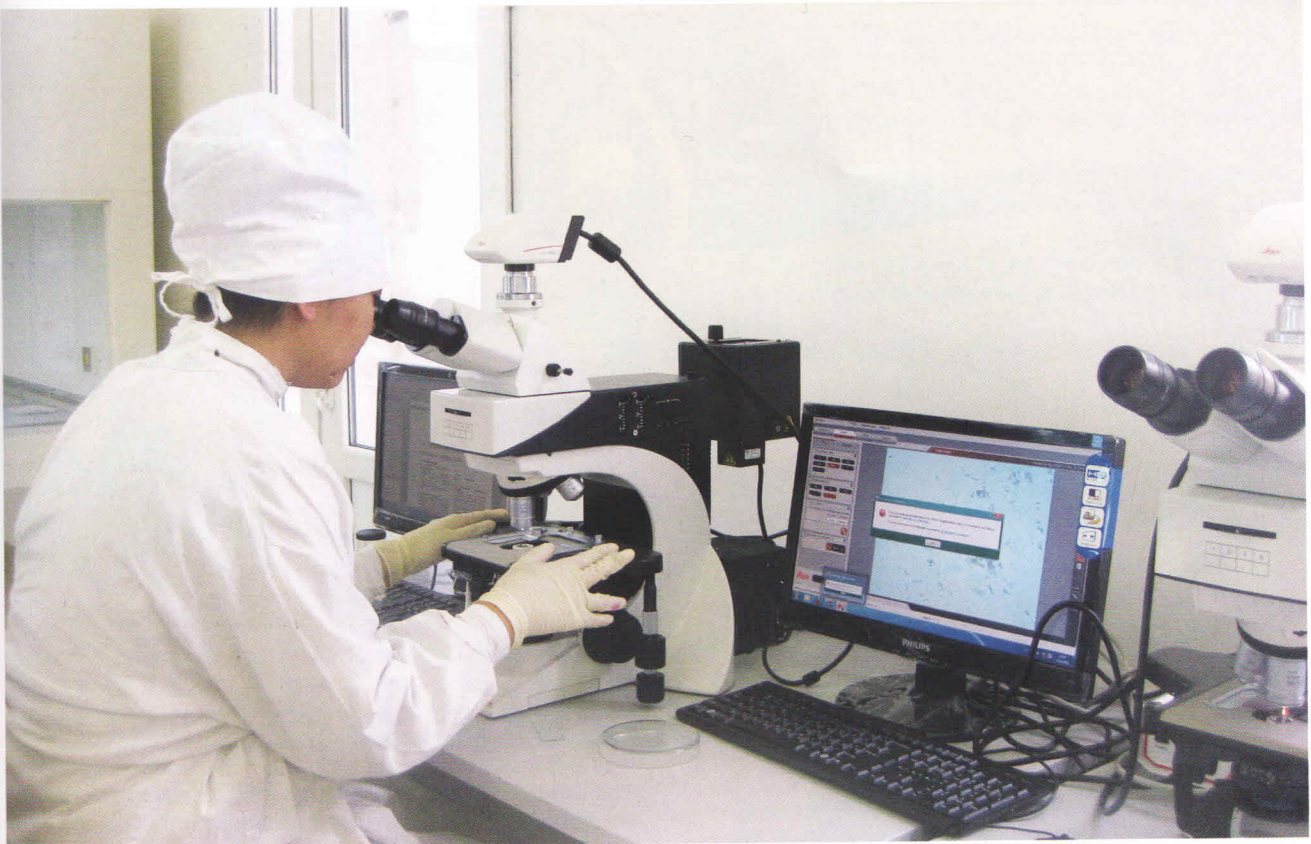
За люминесцентным микроскопом с выводом на монитор. For luminescence microscope with output on the monitor
