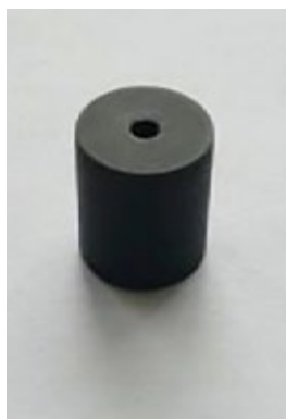
Результат электрической диссоциации образца облученного топлива.
