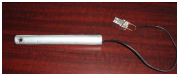
Устройство для обнаружения рака простаты in vivo . Эта часть будет введена в прямую кишку пациента для наблюдения за простатой с помощью ИК-излучения.
