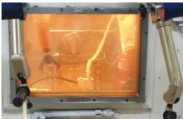
«Горячая» камера с устройством для электрической диссоциации и кислотного выщелачивания образцов облученного топлива.
